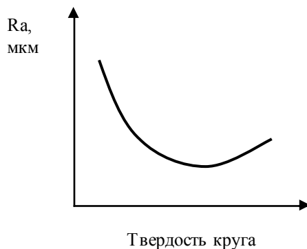
Рис. 1. Зависимость шероховатости по Ra обработанной поверхности от твердости шлифовального круга
